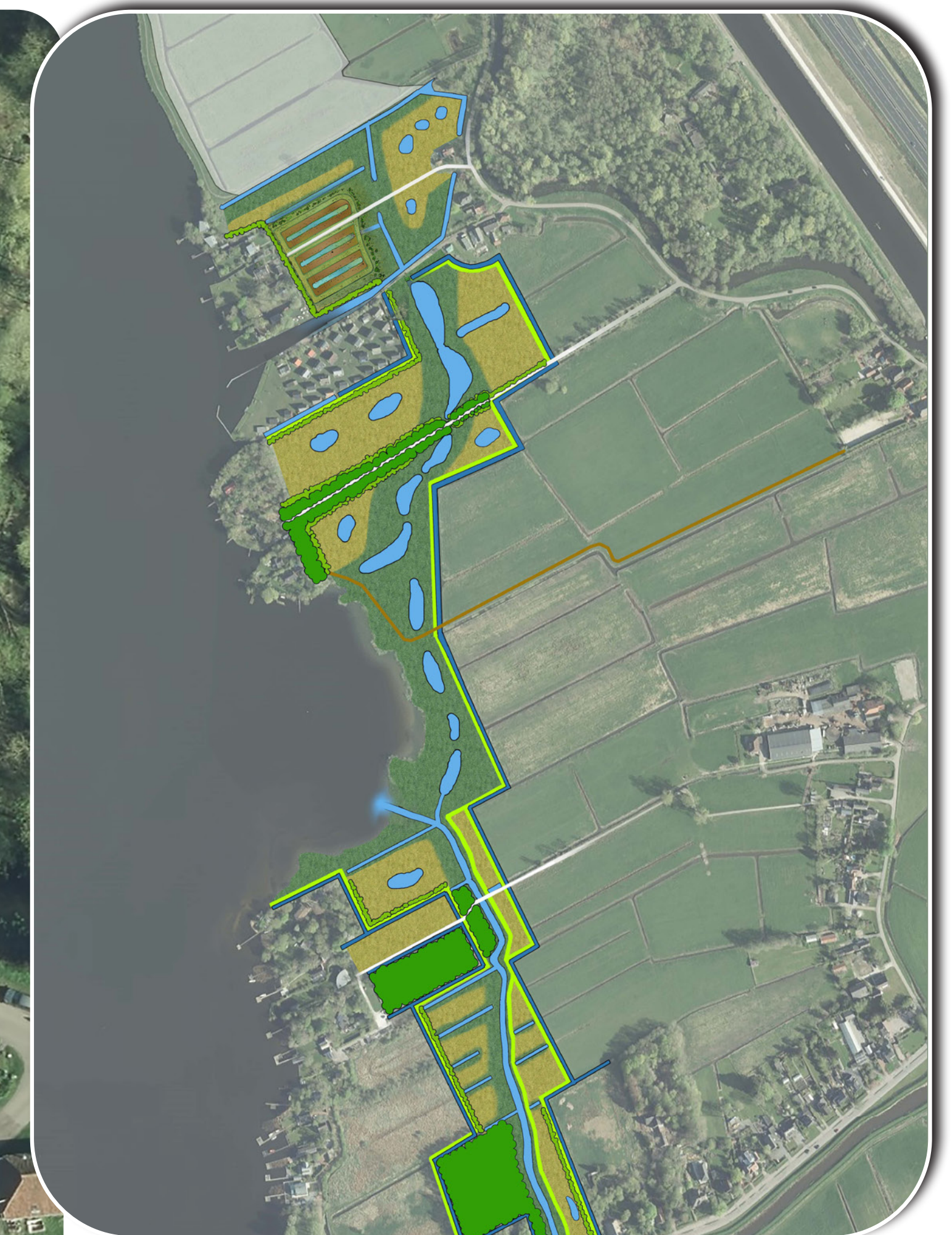
• Uitstroompuit: Afgevoerd water afkomstig van polder Hoornsedijk komt via het gemaal en de uitstroompuit terecht in het bassin. • Overstortput: Bij extreme neerslag situaties zal - zodra het bassin vol is – het water via de overstortput op het oppervlaktewater worden geloosd. • Oeverbekleding: Bij het overstorten is de stroomsnelheid hoger en komen er wervelingen (turbulentie) in het water waardoor erosie van de taluds kan optreden. Een oeverbekleding van bijvoorbeeld beton zorgt ervoor dat deze erosie wordt voorkomen. De oeverbekleding krijgt boven de waterlijn een natuurlijke uitstraling waarop begroeiing o.a. riet kan groeien. • Bestorting: Stortsteen of beton op de bodem van de watergang om ontgroning nabij de instroomput te voorkomen. • Duiker: Buis die twee watergangen met het hetzelfde waterpeil verbindt. In het ijzerzand-bassin kunnen deze afgesloten worden om bijvoorbeeld onderhoud te kunnen plegen aan de bassins. • Drainage buizen: Het water vanuit polder Hoornsedijk zakt door het ijzerzandbed en het gezuiverde stroomt vervolgens via de drainagebuizen terug naar het Paterswoldsemeer.
