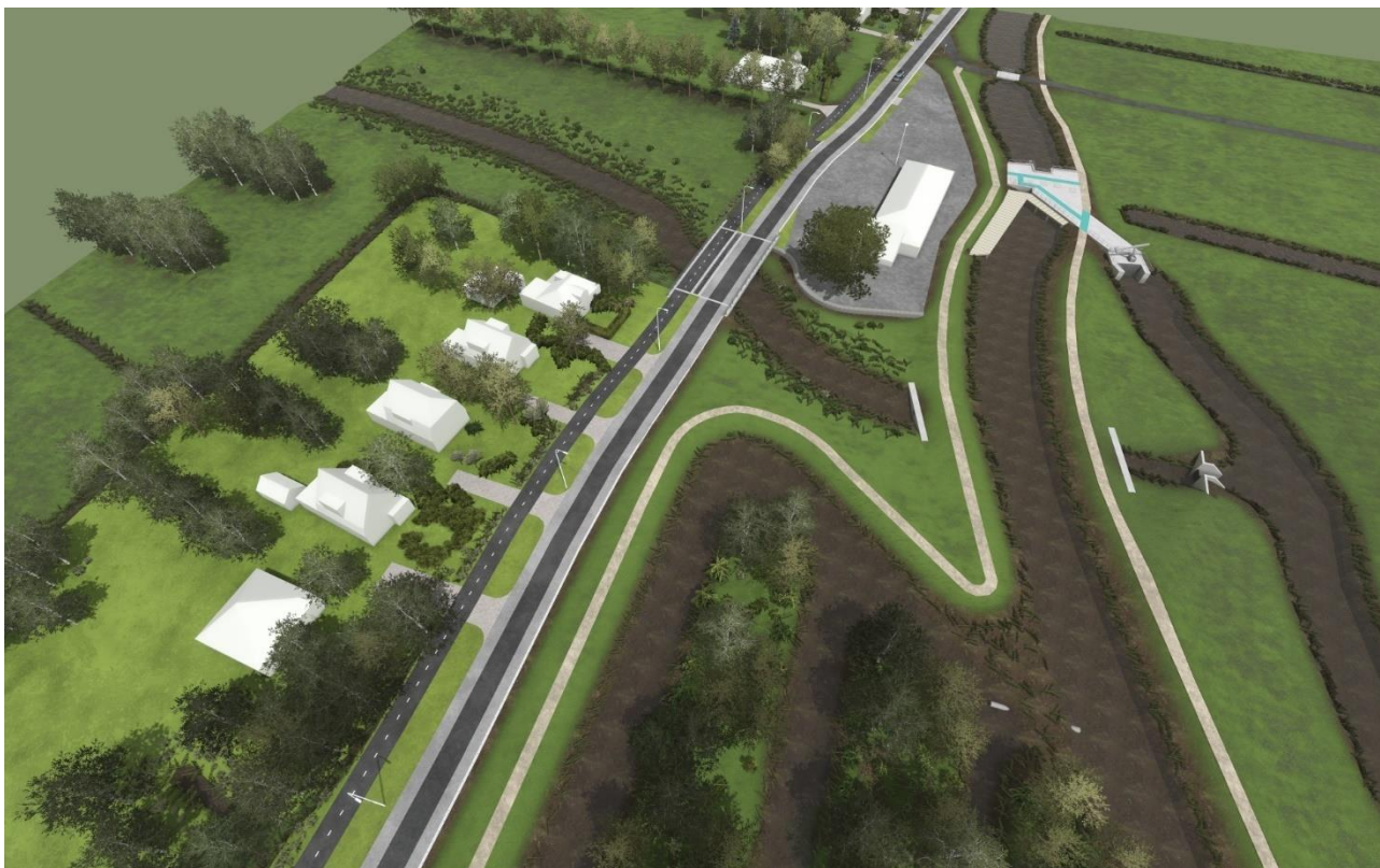
Figuur 10: Impressie toekomstige situatie brug Meerweg met faunapassage en inlaatvoorziening. Daarnaast is het gemaal met de vispassage te zien bij de Schipsloot.
